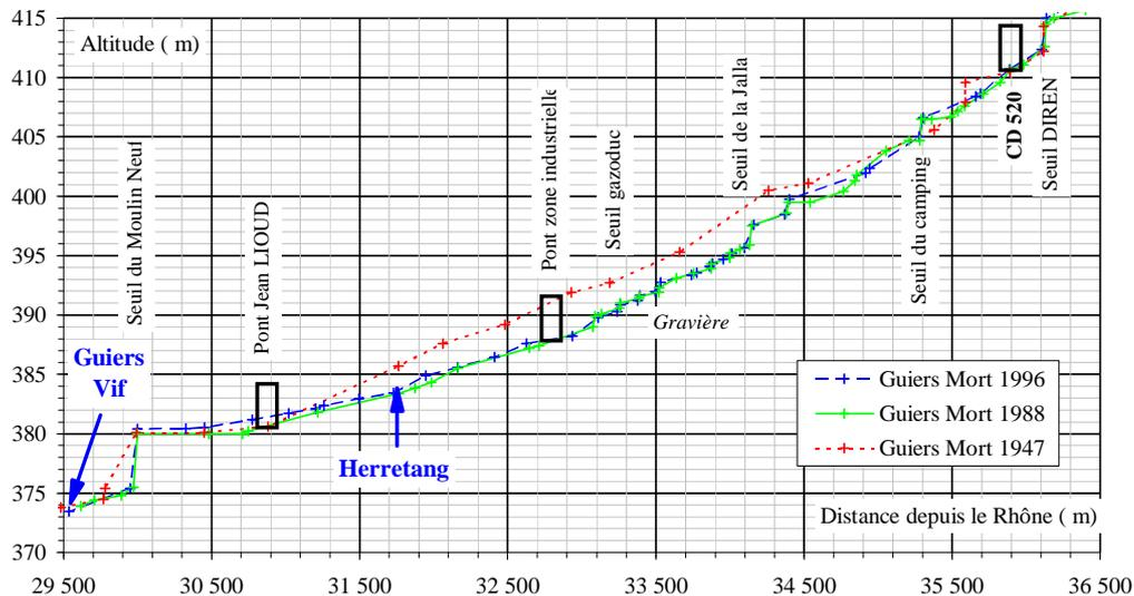
Fig: Comparaison des profils en long de 1947, 1988 et 1996 sur le Guiers Mort (Cedrat).
